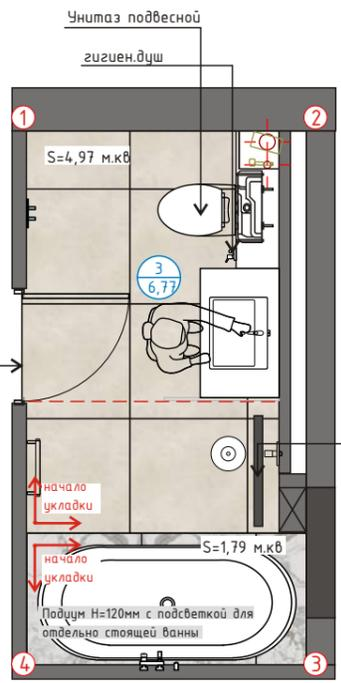
Стык покрытый попадающих в дверной проем предусмотреть под толщиной дверного полотна
